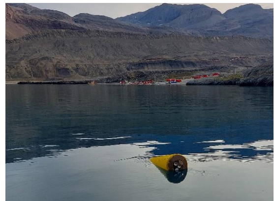
GIOS undervandsinstrumenter udløses akustisk og kommer til havoverfladen efter at have målt et år. Der udsættes nye instrumenter til næste sæson. Foto Søren
