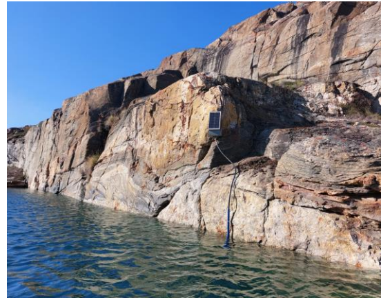
Nyt udviklet GIOS-light undervandsystem. Kan opsamle data fra havet og transmittere data året rundt. Er nu placeret flere steder i fjordsystemerne. Foto Wieter
