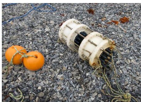
Vandprøvetageren fungerede perfekt. Nu er der indsamlet vandisotoper i fjorden året rundt. Foto Søren
