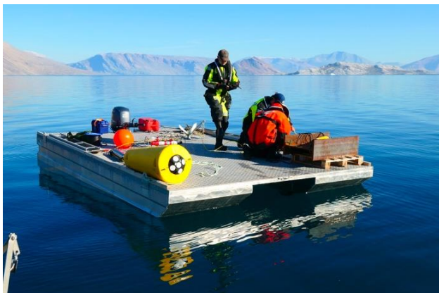
GIOS undervandsinstrumenter udløses akustisk og kommer til havoverfladen efter at have målt et år. Der udsættes nye instrumenter til næste sæson. Foto Søren
