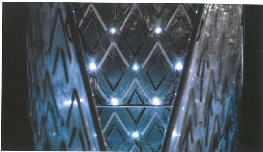
LED-lys tændes når smeltet sne og salt mellem plastiklagene reagerer med metallerne. (Foto: Julien Nolin).
